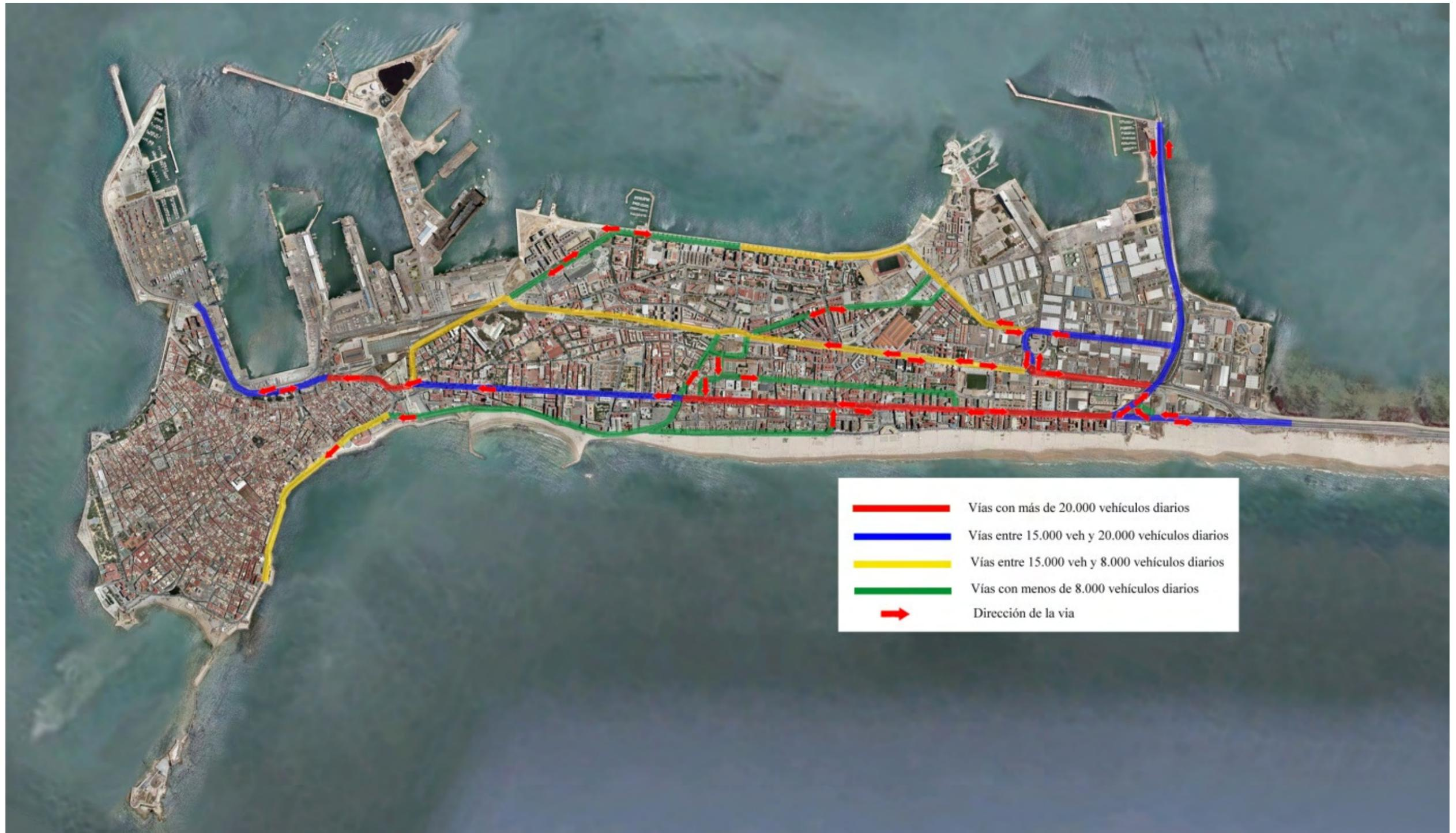
FIGURA 10. INTENSIDAD DE TRÁFICO
