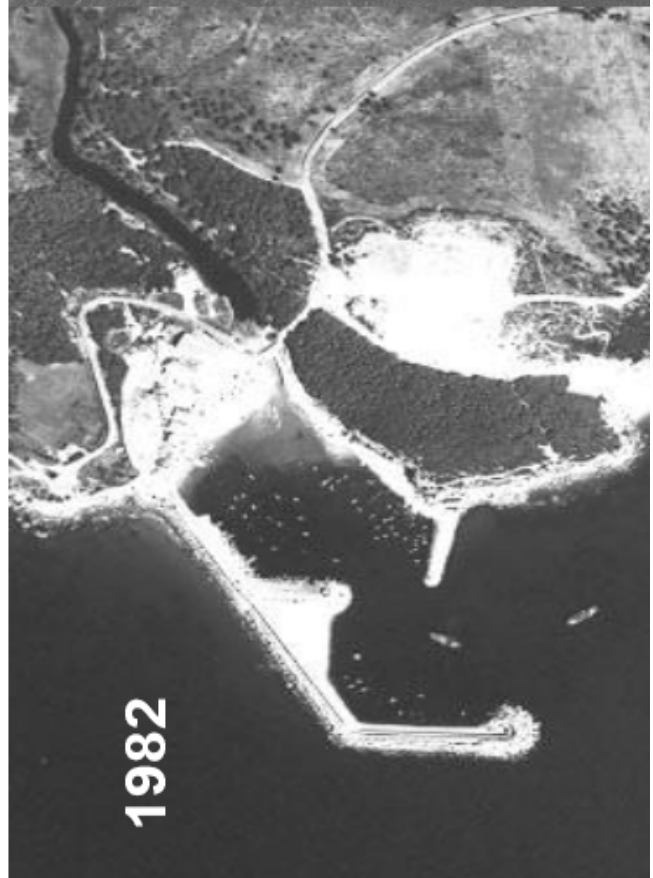
Ilustración 3. Evolución de la desembocadura del río Roche. Obsérvanse los cambios en el tapón arenoso, así como el diferente impacto que ha tenido la obra de abrigo portuario realizada entre 1973 y 1982 en comparación con las hechas (encauzamiento incluido) entre esta última fecha y 1998.
